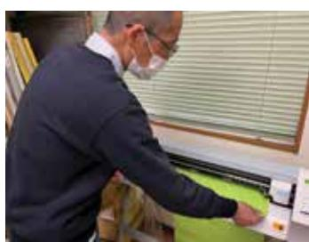
熱圧着方式で印刷されるTシャツやユニフォームの文字や図柄を切り抜く機械です。切り抜かれたシートの不要部分をピンセットで丹念にはがしていくのは人の仕事です。20年近く働いた今までのカッターが老朽化したので、新品に替えていただきました。
